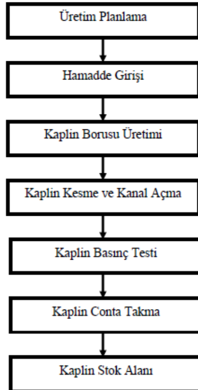
Şekil 5. Kaplin (Manşon) Üretimi Ünitesi İş Akım Şeması
